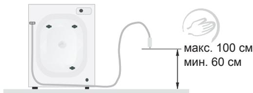
Сливной шланг находится сзади стиральной машины. Закрепите сливной шланг таким образом, чтобы он не перемещался во время работы стиральной машины (используйте для этого колено, как показано ниже). Не опускайте конец сливного шланга слишком глубоко в водосток!
