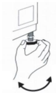
3. Важно: затяните контргайку, повернув ее против часовой стрелки по направлению к корпусу прибора.
