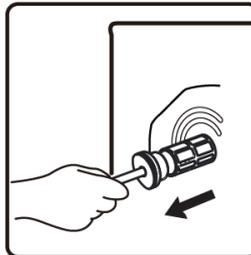
4. Для обеспечения безопасности и снижения уровня шума следует установить пластиковые заглушки, входящие в комплект поставки устройства.
