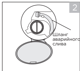
Выньте шланг аварийного слива, вытащите заглушку
