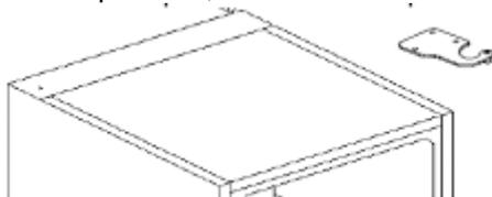
4. Извлеките два винта средней петли. Снимите дверцу морозильника с нижней петли и также положите на мягкую поверхность. Вставьте колпачки крышки холодильника в противоположные отверстия.
