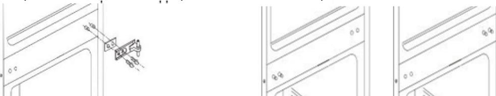
5. Наклоните изделие немного назад и зафиксируйте в этом положении. Отвинтите ножки и снимите кронштейн ножки и петлю дверцы, ослабив винты. Отвинтите ось и вставьте ее с другой стороны петли. Привинтите кронштейн ножки и петлю дверцы на противоположных сторонах и затем снова привинтите ножки.
