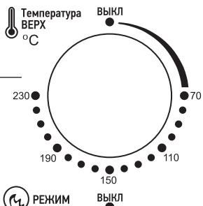
**Установка температуры:** Температура регулируется в диапазоне от 70 до 230 °C. После того, как электродуховка разогрелась до заданной температуры, нагревательный элемент может быть отключен термостатом.
