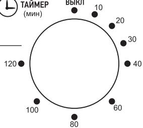
**Таймер:** возможно установить таймер в диапазоне от 0 до 120 мин. Духовка будет всегда работать до отключения ее вручную, при этом горит индикатор работы духовки.
