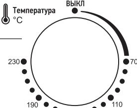
**Установка температуры:** Температура регулируется в диапазоне от 70 до 230 °C. После того, как электродуховка разогрелась до заданной температуры, нагревательный элемент может быть отключен термостатом.
