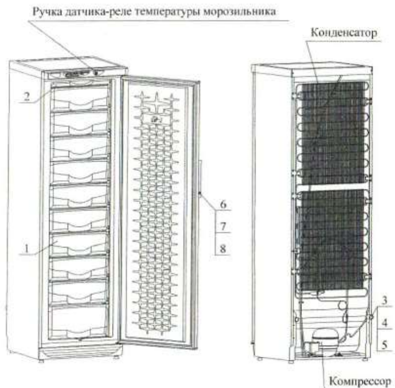
1 – сосуд; 2 – сосуд для ягод; 3 – упор; 4 – винт для крепления упора; 5 – шайба для крепления упора; 6 – ручка; 7 – винт для крепления ручки; 8 – заглушка для винта ручки
