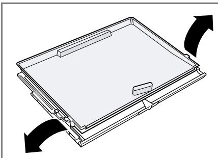
4. Приподнимите крышку ① и выдвиньте ее сзади ②.
