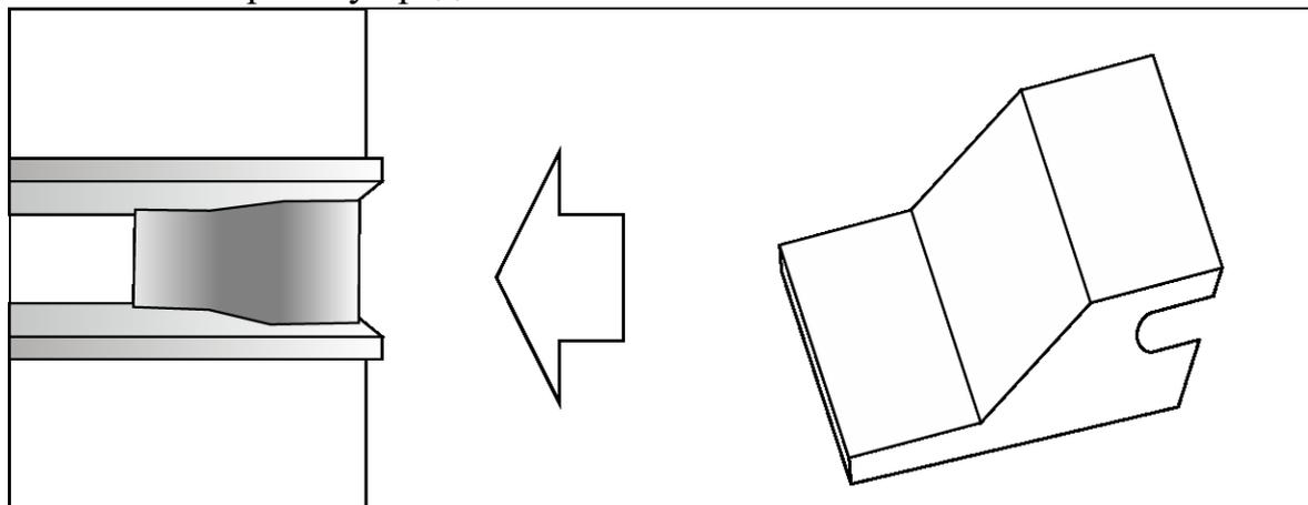
11. Зазор между декоративной панелью и шкафом должен быть менее 1 мм.
