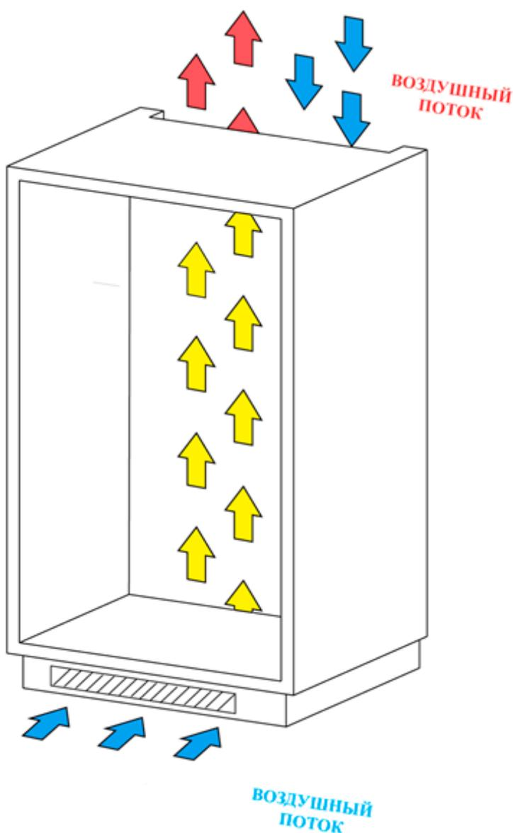
В верхней части шкафа должен быть предусмотрен воздушный канал для свободного входа и выхода воздуха.
