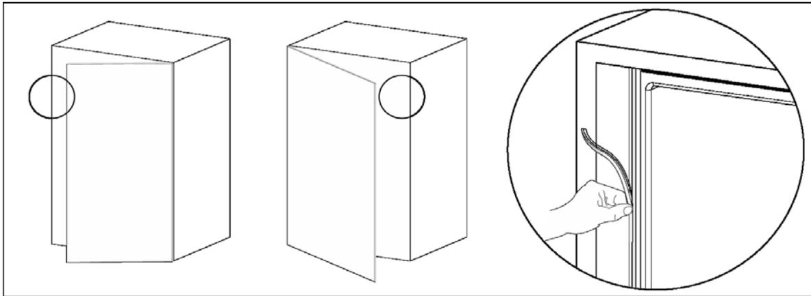
5. Используйте полоску уплотнителя, чтобы заполнить пространство между корпусом и боковой панелью.
