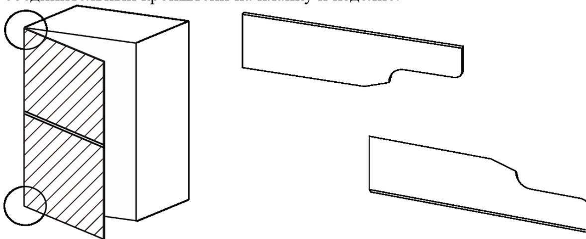
9. Установите крышку шарнира в следующем положении.
