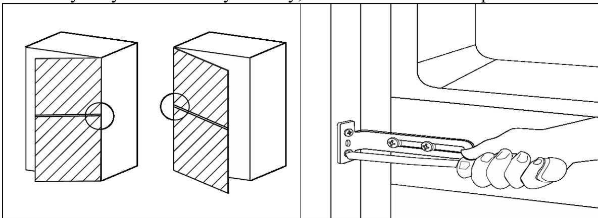
7. Установите соединительную пластину следующим образом, если таковая имеется.
