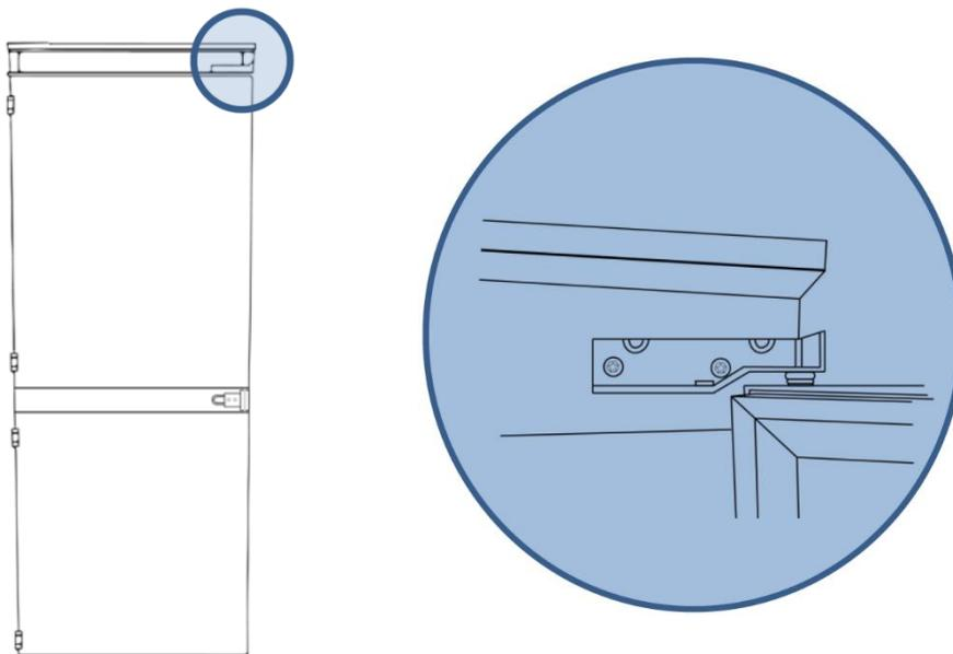
1. Осторожно снимите крышку верхней петли и открутите винты, крепящие верхнюю петлю к прибору, при этом Вы должны поддерживать верхнюю дверцу.
