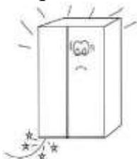
6. Не используйте холодильник с поврежденным или неплотно прилегающим штепселем. Это может вызвать электрический удар, короткое замыкание и пожар. Если сетевой кабель поврежден, для предотвращения опасности он должен быть заменен квалифицированным специалистом сервисного центра Weissgauff.
