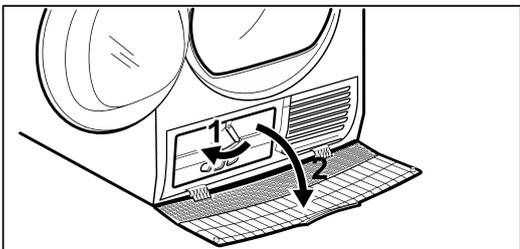
4. При необходимости удалите ворс с конденсатора и из его отсека. Можно использовать пылесос с щеткой.
