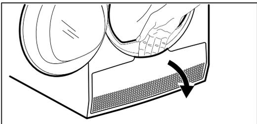
3. Поверните рычаги, чтобы разблокировать крышку конденсатора и опустите крышку.
