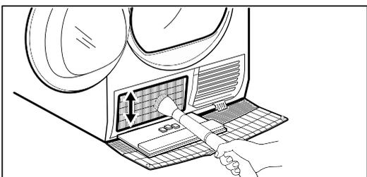
5. Закройте крышку конденсатора.
