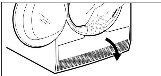
3. Поверните рычаг, чтобы разблокировать крышку конденсатора, и опустите ее.
