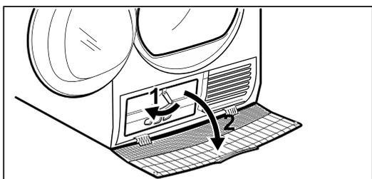
4. Возьмите трубку, расположенную на левой стенке отсека. Откройте крышку, чтобы слить воду.
